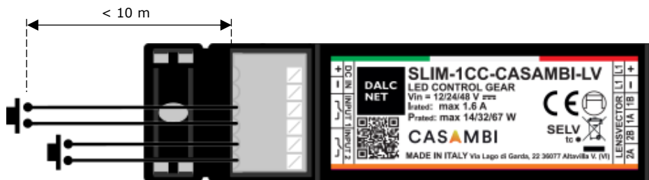
Figura 3: Schema di collegamento del comando locale per brevi distanze
