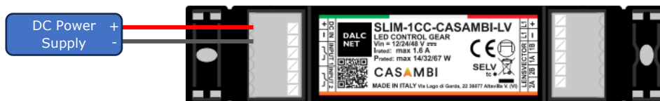
Figura 5: Schema di collegamento dell'alimentazione
